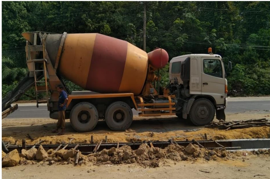
Gambar 3. 10 Concrete Mixer Truck Sumber : dokumentasi lapangan 2022
