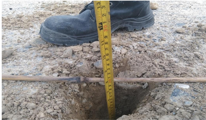
Gambar 3. 16 Test Pit Base B Sumber : dokumentasi lapangan 2022
