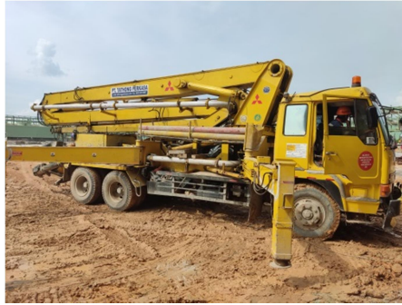
Gambar 2. 9 Concrete Pump Sumber : Dokumentasi lapangan, 2022
