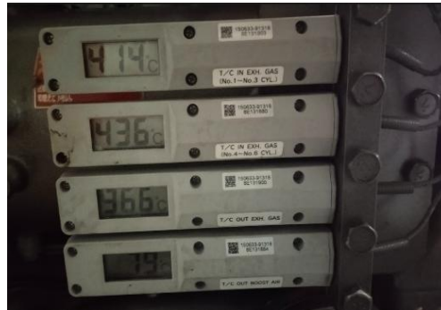
Gambar 2. 14 Pencatatan Suhu Gas Buang pada Cylinder No. 1-6, Suhu Gas Buang yang Dikeluarkan, dan Suhu Udara Tambahan.
