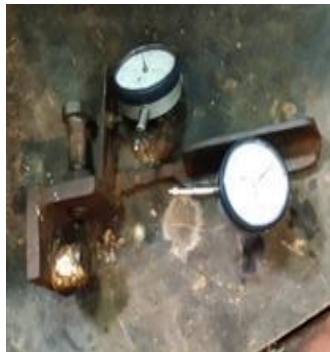
Gambar 3. 4 Dial Gauge Untuk Mengukur Misalignment
