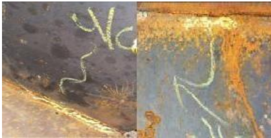
Gambar 2. 86 cacat las high low
