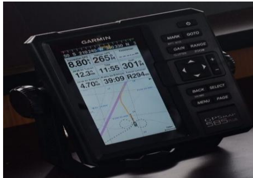
Gambar 2. 18 Pola Gerakan Kapal Saat Turning Circle Test
