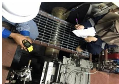
Gambar 2. 15 Pencatatan Temperatur Cooling Engine dan Sistem Poros Kapal
