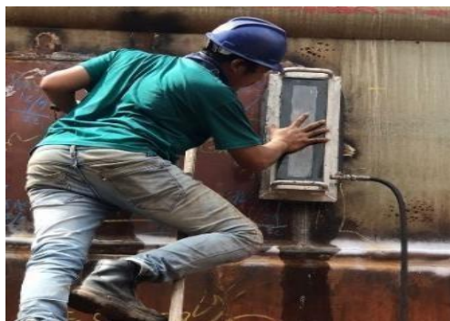
Gambar 2. 27 Meletakkan alat vacuum diatas kambuh las.
