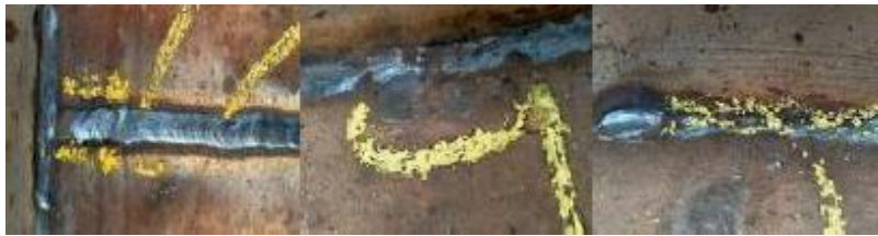
Gambar 2. 29 Hasil Visual Welding dan cacat las Porosity,poor stop/start
