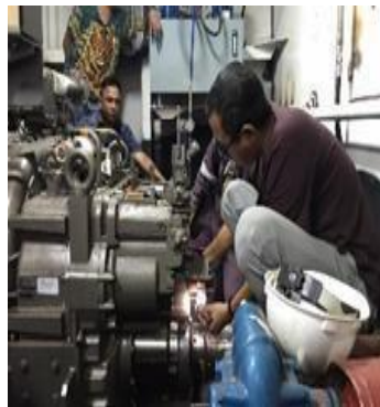
Gambar 3. 8 Dial Gauge Untuk Mengukur Crank Shaft Deflection
