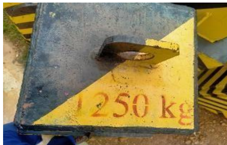
Gambar 2. 55 Beban yang digunakan untuk inclining test
