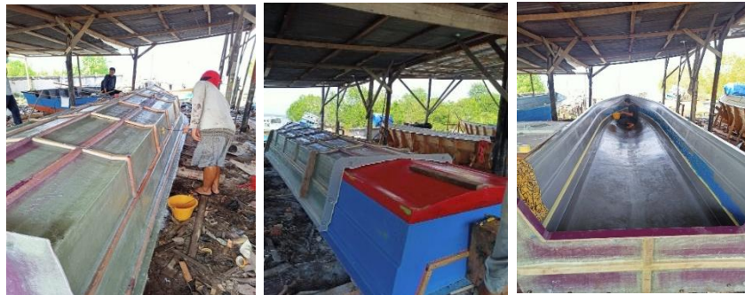
Gambar 2.1 Pembuatan cetakan kapal katinting
