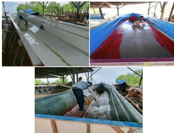
Gambar 3. 4 Proses dempul, geol coat, dan laminasi
