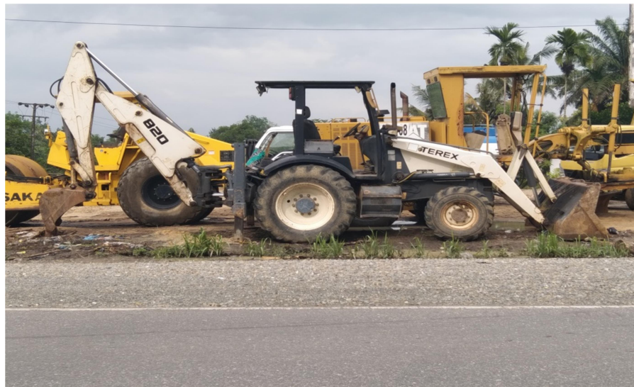
Gambar 3. 9 Backhoe Loader Sumber : dokumentasi lapangan 2022
