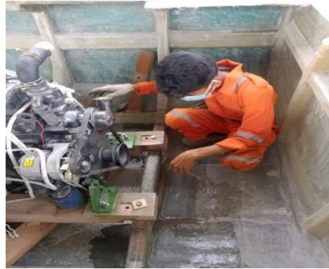
Gambar 3. 2 Penentuan kedudukan Sumbu Baling-baling ( Propeller )
