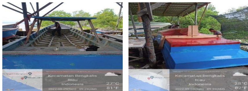
Gambar 2.4 Pemasangan atap kapal 1 GT dan laminasi cetakan positif kapal 2 GT
