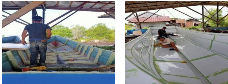
Gambar 2.2 Pemasangan gading dan mirror kapal 1 dan 2 GT
