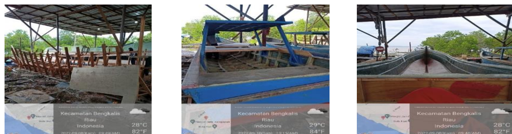
Gambar 2.5 Laminasi kapal 2 GT serta proses pembuatan cetakan kapal 3 GT
