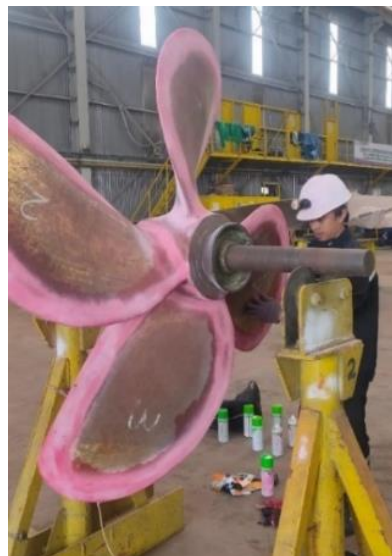
Gambar 2. 29 Propeller setelah penetration
