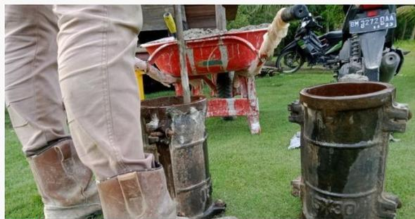
Gambar 3.28 Pengambilan Sampel Silinder
