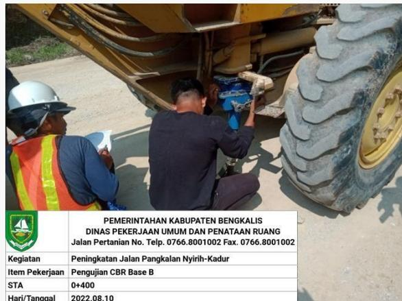
Gambar 3.7 Pengujian CBR Lapangan
