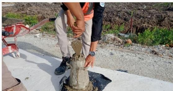
Gambar 4.8 Pengujian *Slump*
