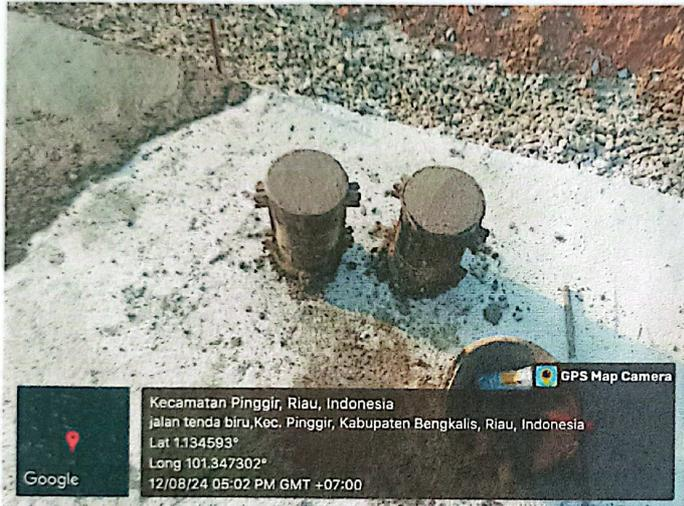
Pembuatan sampel beton untuk lc, sampel yang digunakan yaitu silinder
