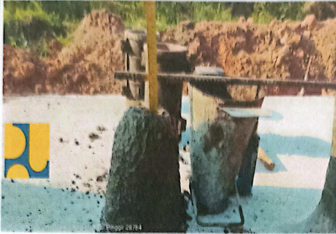
Uji slump lapangan dilakukan untuk mengecek kecekan beton dan juga mutu beton.
