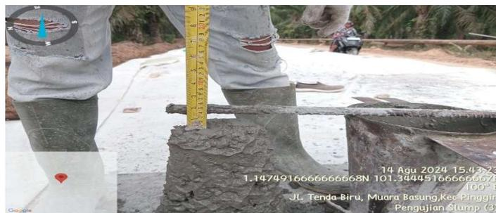
Gambar 3 24. Uji Slump
