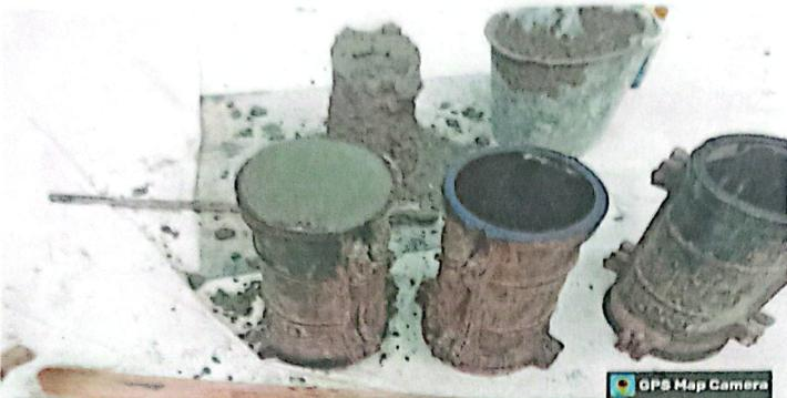
Pembuatan sampel beton untuk rigid, sampel yang digunakan yaitu silinder
