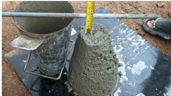
Gambar 3. 24 Pengujian Slump Test
