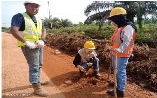
*Gambar 3. 3 Penge-corte-an Tanah Urugan*
