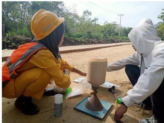
Gambar 3. 8 Pengujian Sand Cone
