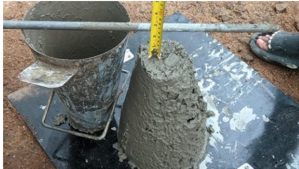
Gambar 3. 24 Pengujian Slump Test
