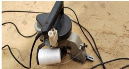
**Gambar 3. 20** Mesin Penjahit Geotextile
