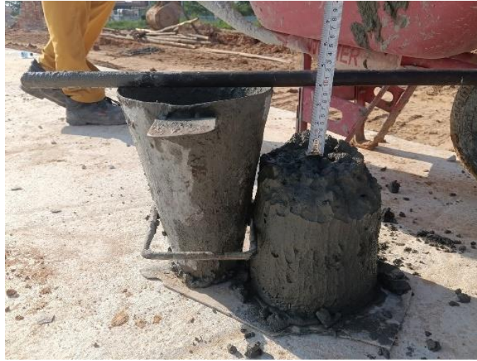
Gambar 3.69 Slump Test ( Sumber: Dokumentasi Lapangan, 2024)
