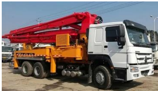
Gambar 2.16 Concrete Pump (Sumber :Dokumentasi Lapangan,2024)
