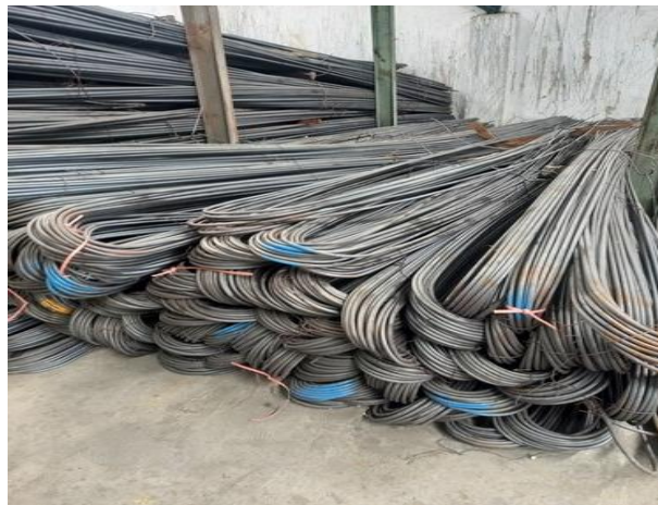
Gambar 2.9 Besi Tulangan (Sumber :Dokumentasi Lapangan,2024)
