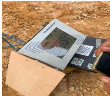
Gambar 3.48 Tampilan PDA test pada Layar (Sumber: Dokumentasi Lapangan, 2024 )
