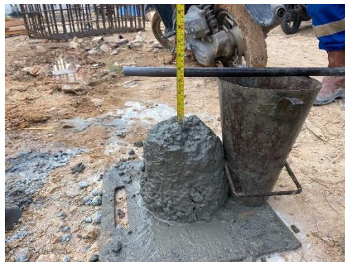
Gambar 3.14 Slump Test (Sumber: Dokumentasi Lapangan, 2024)
