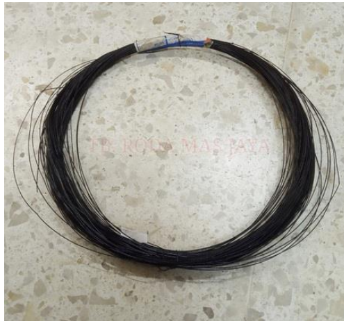
Gambar 2.10 Kawat Bendrat (Sumber :Dokumentasi Lapangan,2024)
