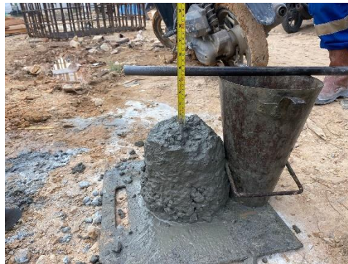
Gambar 3.36 Slump Test (Sumber: Dokumentasi Lapangan, 2024)
