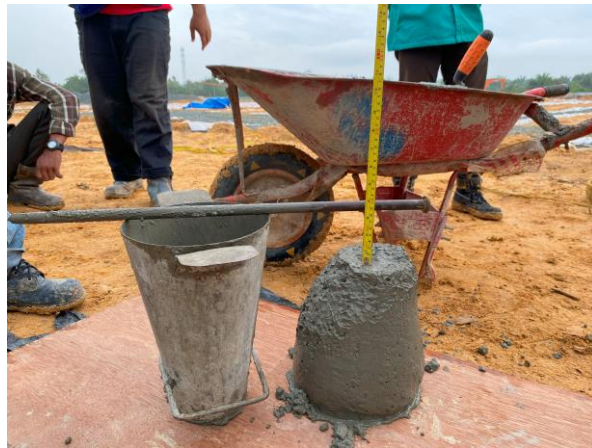
Gambar 3.59 Slump Test (Sumber: Dokumentasi Lapangan, 2024)
