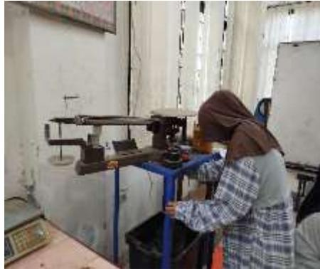
Gambar 3. 23 Pengujian Berat Jenis Agregat
