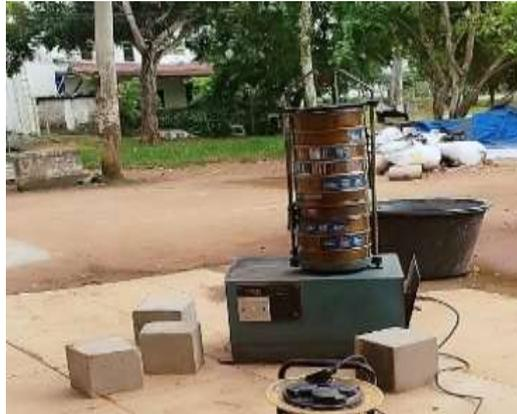
Gambar 3. 21 Pengujian Analisa Saringan
