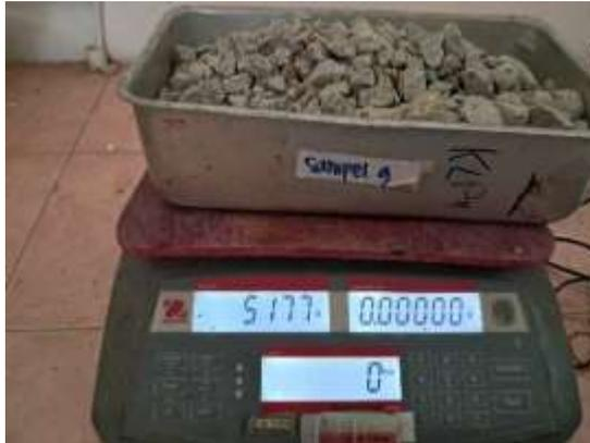
Gambar 3. 22 Pengujian Kadar Air Agregat
