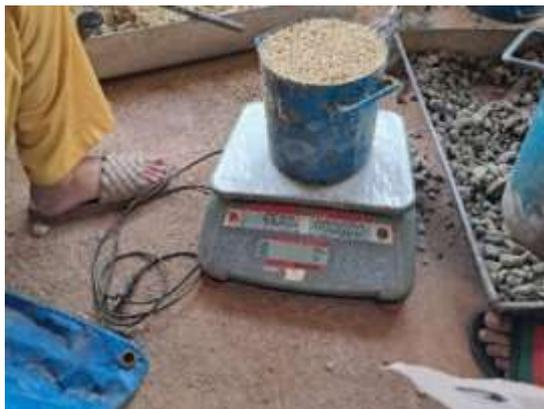
Gambar 3. 20 Pengujian Berat *Volume* Agregat Halus
