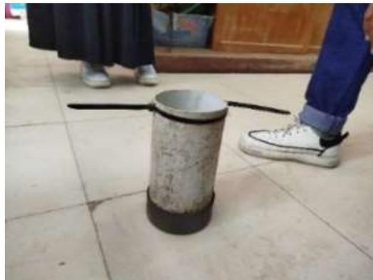
Gambar 3. 7 Cetakan Silinder
