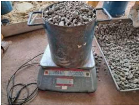
Gambar 3. 19 Pengujian Berat *Volume* Agregat Kasar
