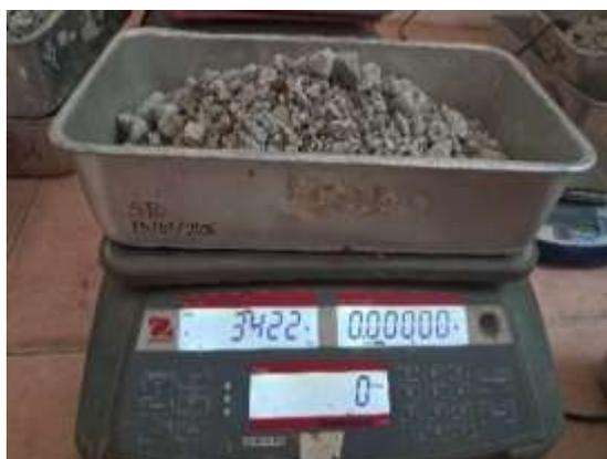
Gambar 4. 2 Sampel Pemeriksaan Keausan Agregat
