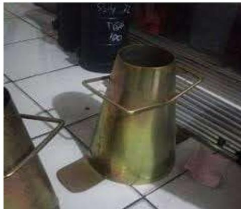
Gambar 3. 3 Alat *Slump*
