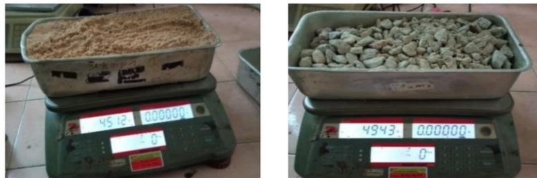
Gambar 2.6.2 sampel agregat untuk pengujian kadar air agregat (sumber: dokumentasi skripsi 2025)
