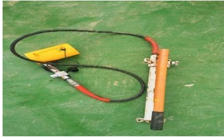
Gambar 3.25 pompa piston uji lentur
