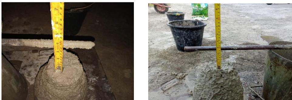
Gambar 3.33 sampel uji slump
