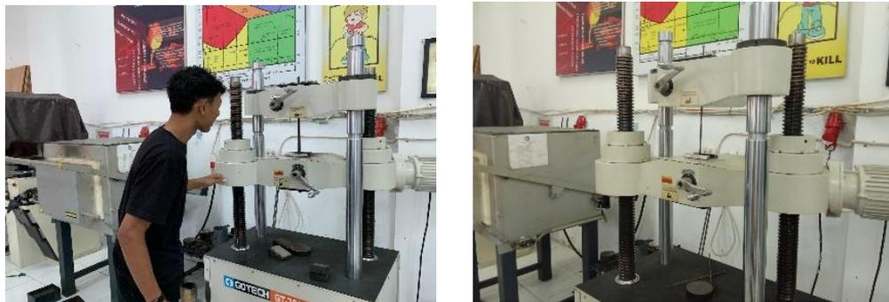
gambar 3.37 pengujian kuat Tarik tulangan baja di gedung teknik mesin
