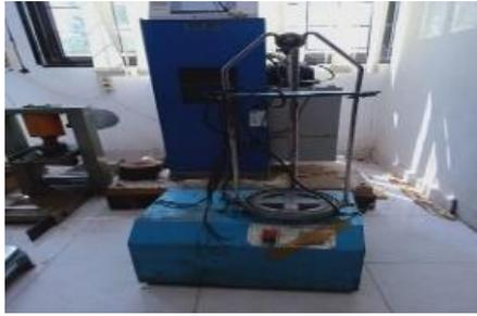
Gambar 3.12 mesin siver shaker / uji saringan
