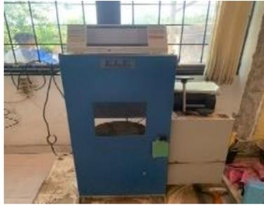
Gambar 3.9 mesin uji tekan silinder
