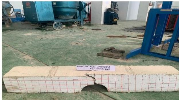
Gambar.4.55 Sampel lentur yang terjadi kegagalan cabut (*Pull Out Failure*)
