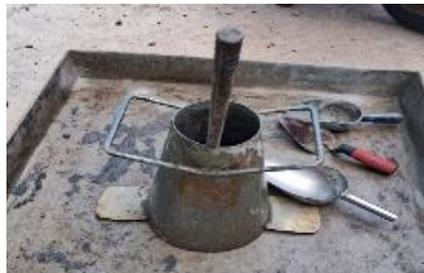
Gambar 3.8 kerucut uji slump
