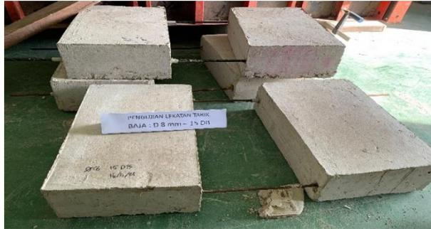
(Gambar.4.54 Sampel uji tarik yang terjadi kegagalan cabut (*Pull Out Failure*))
