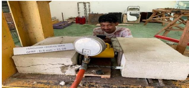
Gambar.4.56 Sampel yang terjadi kegagalan belah beton (*concrete splitting failure*)
