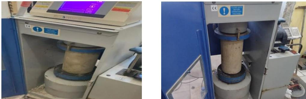
Gambar 3.38 pengujian kuat tekan beton
