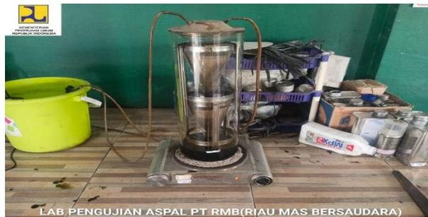
**Gambar 3. 26 Pengujian Refluks Di Lab PT. RMB**
