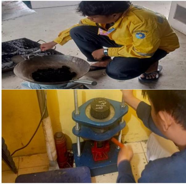
**Gambar 3. 27 Pembuatan sampel marshal**
