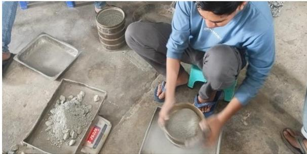
**Gambar 3. 28 Analisa Saringan Agregat**
