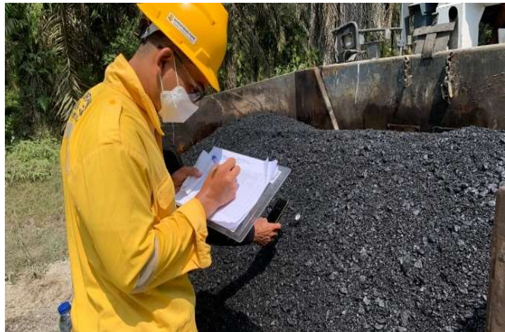
Gambar 4 4: pengambilan suhu pada finisher
