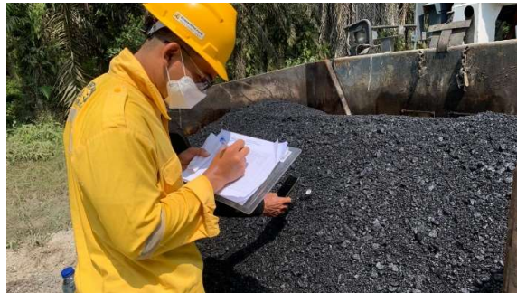
Gambar 3 30 Pengecekan suhu di Finisher
