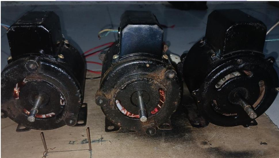
Gambar 4.1 tiga motor induksi 1 fasa
