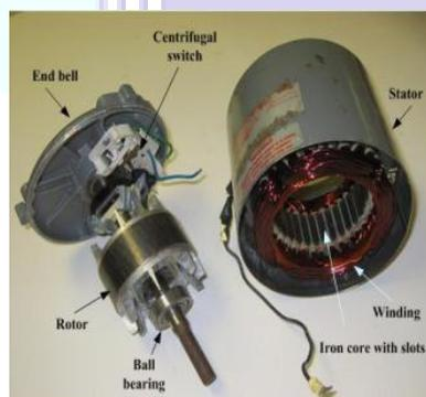
Gambar 2.2 bagian-bagian stator (sumber: motor-motor listrik, 2025)
