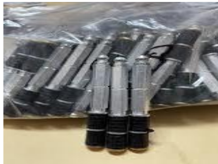
Gambar 3.53 Packers (alat injeksi ) (Sumber : Dokumentasi lapangan, 2024)
