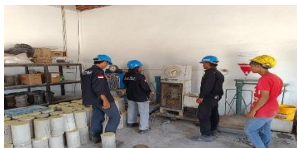
Gambar 3.39 Pengujian kuat tekan beton (Sumber : Dokumentasi lapangan, 2024)
