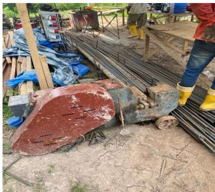
Gambar 3.24 Alat pemotong besi
