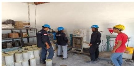
Gambar 3.39 Pengujian kuat tekan beton
