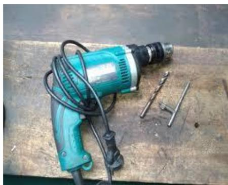
Gambar 3.62 Mesin bor tangan
