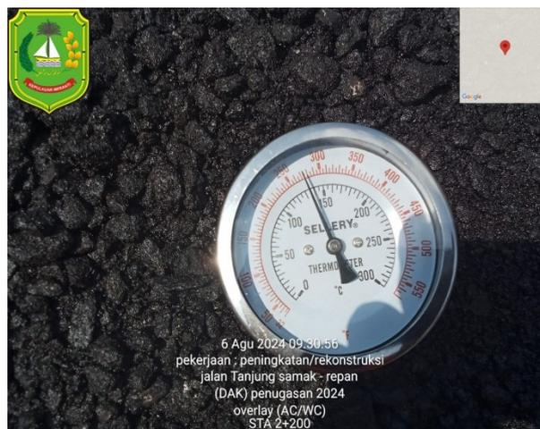
*Gambar 1. 13 . Thermometer Asphalt*
