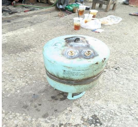
Gambar 4. 13 Tangki setelah dilas dan dipasang heater
