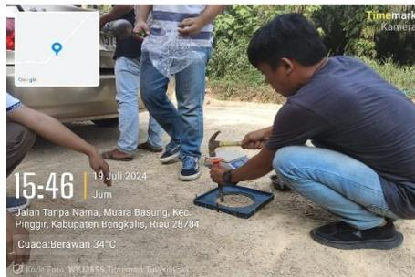
*Gambar 3. 10 Pengujian Sand Cone*
