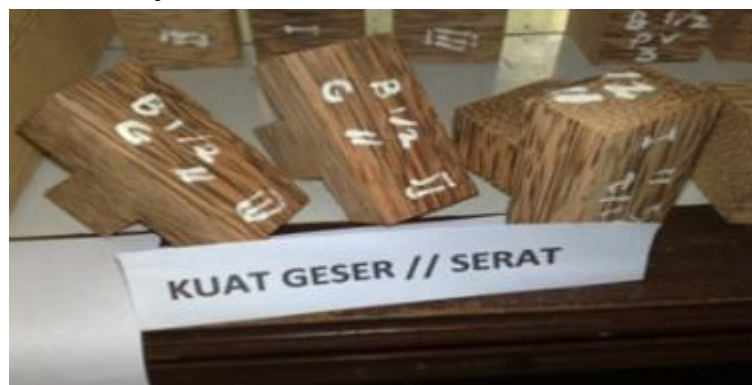
Gambar 2. 4 Contoh Benda Uji Kuat Geser (Sumber: Dokumen Pribadi,2025)
