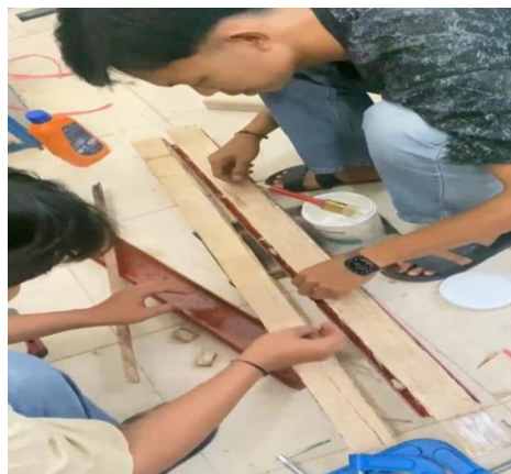
Gambar 3. 19 Proses pengeleman (Sumber: Dokumentasi pribadi, 2025)
