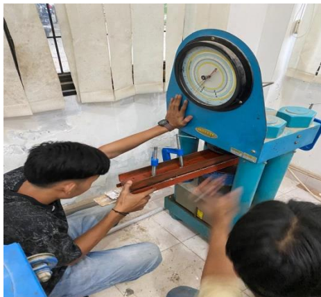
Gambar 3. 21 Pengempaan Benda Uji (Sumber: Dokumentasi pribadi, 2025)
