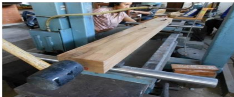
Gambar 2. 6 Contoh Benda Uji Kuat Lentur (Sumber: Dokumen Pribadi, 2025)
