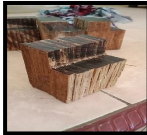
Gambar 3. 27 Pembuatan benda uji kuat geser (Sumber: Dokumentasi pribadi, 2025)
