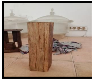
Gambar 3. 25 Pembuatan benda uji kuat tekan (Sumber: Dokumentasi pribadi, 20250)
