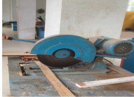
Gambar 3.3 Mesin pemotong kayu/ circular saw (sumber: Dokumentasi Pribadi, 2025)
