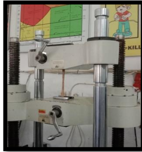
Gambar 3. 30 Proses pengujian kuat tarik (Sumber: Dokumentasi pribadi, 2025)
