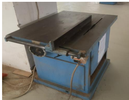
Gambar 3.2 Mesin meja pemotong/Table saw (sumber: Dokumentasi Pribadi, 2025)
