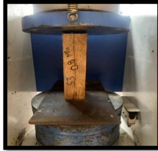
Gambar 3. 26 Proses pengujian kuat tekan kayu (Sumber: Dokumentasi pribadi, 2025)
