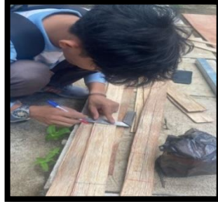
Gambar 3. 29 Pembuatan benda uji kuat tarik (Sumber: Dokumentasi pribadi, 2025)
