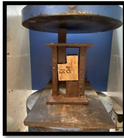
Gambar 3. 28 Proses pengujian kuat geser (Sumber: Dokumentasi pribadi, 2025)
