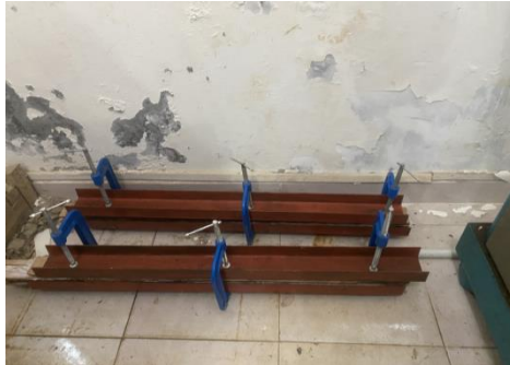
Gambar 3. 23 Sampel yang sudah pengempaan (Sumber: Dokumentasi pribadi, 2025)
