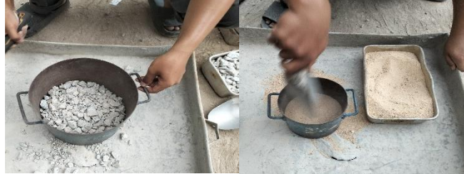
Gambar 3. 47 Masukkan agregat secara bertahap (Sumber : Dokumentasi Tugas Akhir, 2025)
