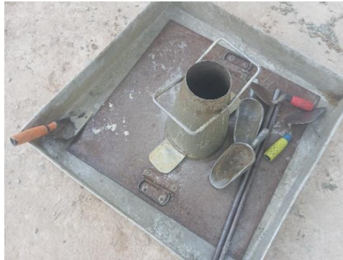
Gambar 3. 16 Alat Uji Slump (Sumber : Dokumentasi Tugas Akhir, 2025)
