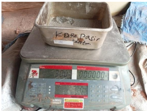
Gambar 3. 64 Timbang Semen (Sumber : Dokumentasi Tugas Akhir, 2025)
