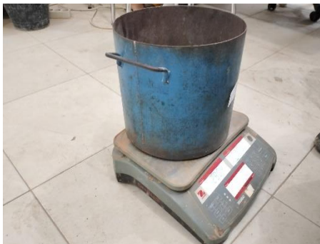
Gambar 3. 46 Timbang berat mould (Sumber : Dokumentasi Tugas Akhir, 2025)
