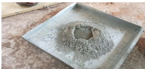
Gambar 3. 65 Tuang Air perlahan (Sumber : Dokumentasi Tugas Akhir, 2025)
