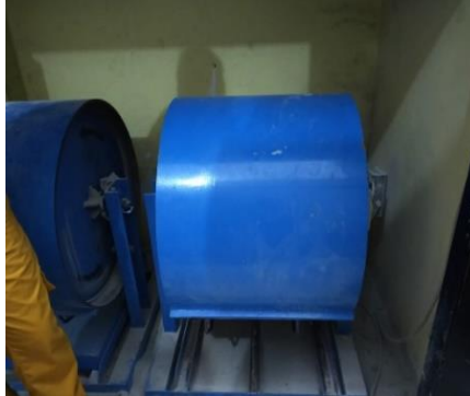
Gambar 3. 11 Mesin loss angeles (Sumber : Dokumentasi Tugas Akhir, 2025)
