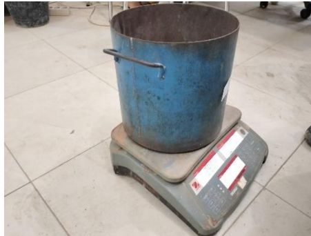
Gambar 3. 50 Timbang berat mould (Sumber : Dokumentasi Tugas Akhir, 2025)
