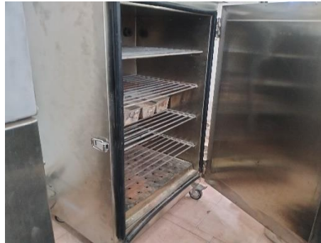
Gambar 3. 35 Masukkan benda uji + Wadah kedalam oven (Sumber : Dokumentasi Tugas Akhir, 2025)
