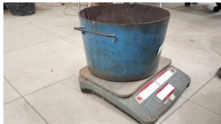
Gambar 3. 54 Timbang berat mould (Sumber : Dokumentasi Tugas Akhir, 2025)
