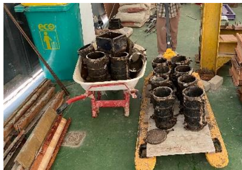
Gambar 3. 17 Cetakan Silinder (Sumber : Dokumentasi Tugas Akhir, 2025)
