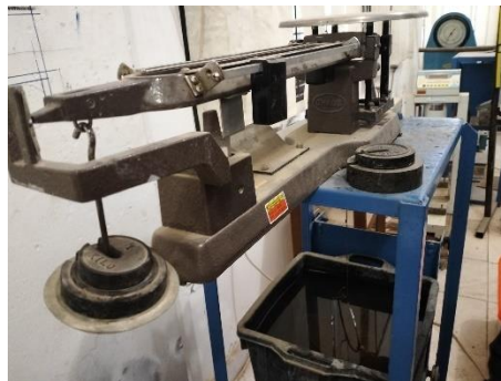
Gambar 3. 42 Timbang sampel + Wadah (Sumber : Dokumentasi Tugas Akhir, 2025)
