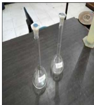
Gambar 3. 13 Picnometer (Sumber : Dokumentasi Tugas Akhir, 2025)
