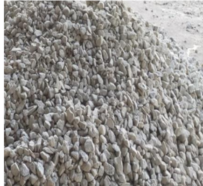
Gambar 3. 21 Agregat Kasar (Sumber : Dokumentasi Tugas Akhir, 2025)
