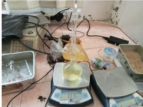
Gambar 3. 59 Timbang Botol dan kerosin (Sumber : Dokumentasi Tugas Akhir, 2025)
