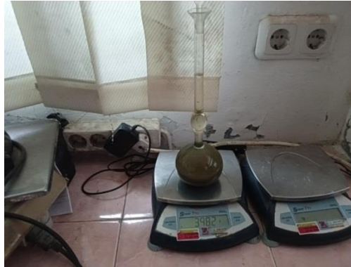
Gambar 3. 61 Timbang Botol Le Chartelier dan Isi (Sumber : Dokumentasi Tugas Akhir, 2025)
