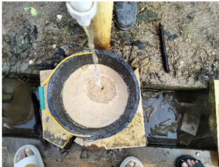
Gambar 3. 37 Mencuci agregat yang sudah lolos saringan No.200 (Sumber : Dokumentasi Tugas Akhir, 2025)
