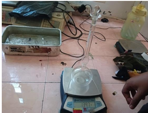
Gambar 3. 58 Timbang Botol Le Chartelier (Sumber : Dokumentasi Tugas Akhir, 2025)
