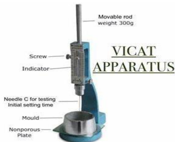
Gambar.2. 3 Vicat Apparatus (Sumber : Google, 2025)
