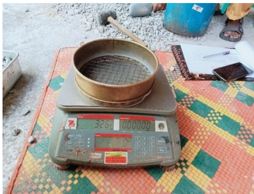
Gambar 3. 29 Menimbang setiap saringan (Sumber : Dokumentasi Tugas Akhir, 2025)
