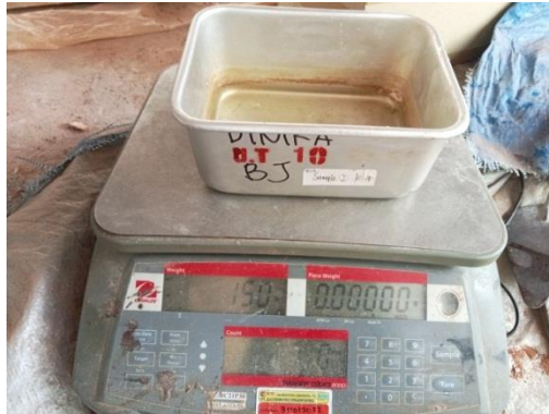
Gambar 3. 63 Timbang Air (Sumber : Dokumentasi Tugas Akhir, 2025)
