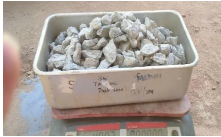
Gambar 3. 38 Timbang berat sampel yang telah dioven seberat 1000 gram (Sumber : Dokumentasi Tugas Akhir, 2025)
