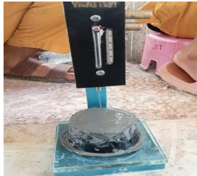
Gambar 3. 67 Posisikan cincin pada plat kaca (Sumber : Dokumentasi Tugas Akhir, 2025)
