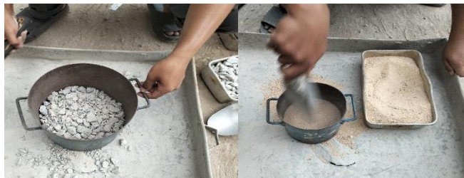
Gambar 3. 51 Masukkan agregat secara bertahap (Sumber : Dokumentasi Tugas Akhir, 2025)
