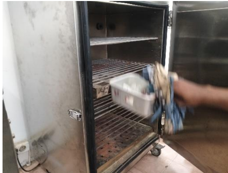
Gambar 3. 31 Masukkan benda uji + wadah dalam oven (Sumber : Dokumentasi Tugas Akhir, 2025)
