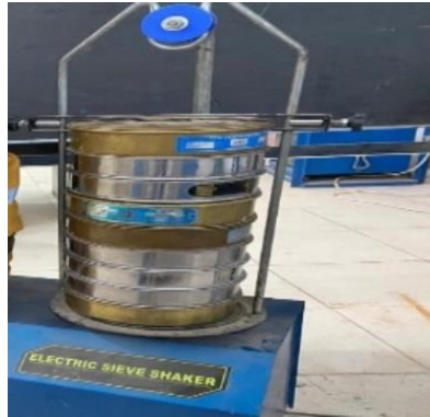
Gambar 3. 33 Alat pengujian analisa saringan (Sumber : Dokumentasi Tugas Akhir, 2025)
