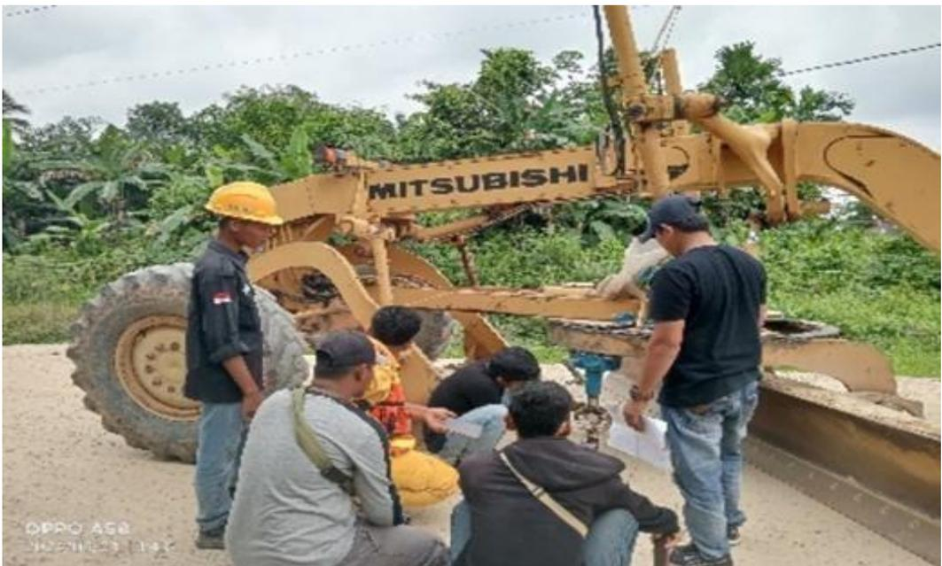
**Gambar 4. 7** Pengujian CBR
