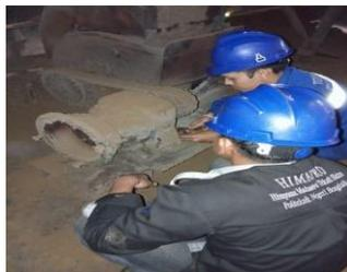
**Gambar 3.69 Pemindahan gearbox elektro motor**
