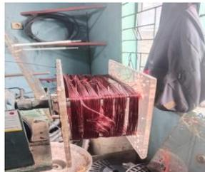
**Gambar 3.55 Penggulangan *email drat* elektro motor 3P 1500 RPM**
