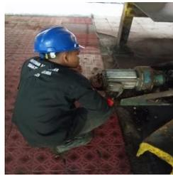
**Gambar 3.63 Perawatan elektro motor 3 phasa**
