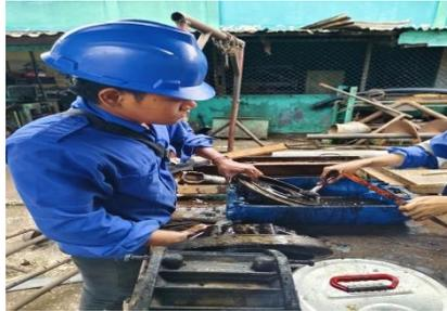
**Gambar 3.31 Pembongkaran elektro motor 3 phasa *vibrating screen***
