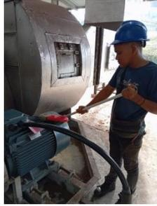
**Gambar 3.120 Perawatan elektro motor 3P**
