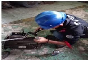
**Gambar 3.44 Pembongkaran elektro motor 3 phasa**
