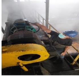
**Gambar 3.36 Perawatan elektro motor 3 phasa di
