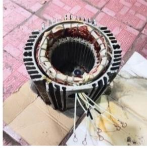
**Gambar 3.96 Penyiraman serlak elektro motor 3P**
