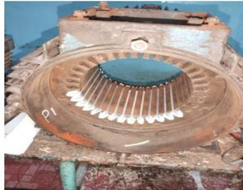
**Gambar 3.89 Pemasangan plastic prespan ke elektro motor 3P**
