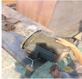
**Gambar 3.48 Perakitan elektro motor 3 phasa**
