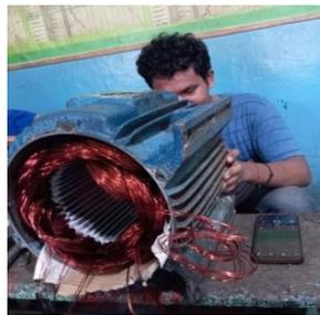
**Gambar 3.101 Pemasangan *email drat* elektro motor 15 KW**
