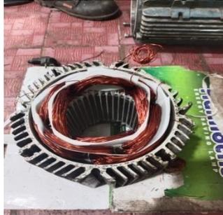
**Gambar 3.94 Pemasangan plastic prespan pembatas *email drat***
