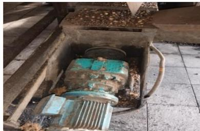
**Gambar 3.8 Pembersihan/perawatan gearbox kumparan elektro motor 3 phasa**
