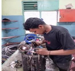
**Gambar 3.79 Pembongkaran elektro motor 3P**
