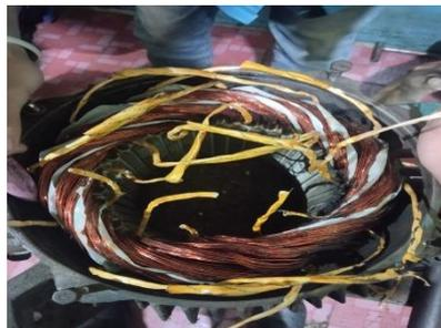
**Gambar 3.3 Bongkar elektro motor *ripple mill***
