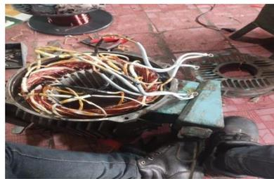
**Gambar 3.26 Pemasangan kabel *connect star* dan *delta* elektro motor 3 phasa**
