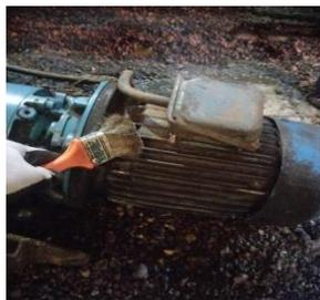
**Gambar 3.66 Perawatan elektro motor 3P**
