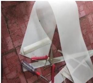
**Gambar 3.83 Pemasangan plastik prespan**
