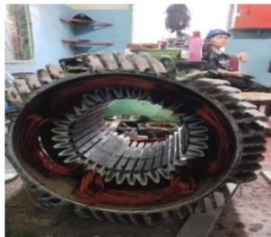
**Gambar 3.92 Pemasangan *email drat* elektro motor**
