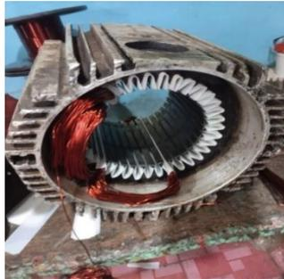
**Gambar 3.91 Pemasangan *email drat* elektro motor**
