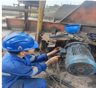
**Gambar 3.43 Penggantian elektro motor 3 phasa pada meja grading**
