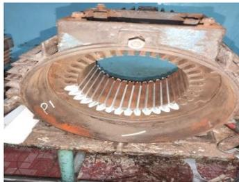
**Gambar 3.28 Pemasangan *plastic* prespan pada elektro motor 3 phasa**
