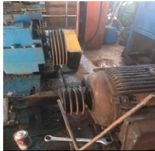
**Gambar 3.87 Penggantian *pulle screw press***
