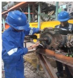
**Gambar 3.47 Penggantian bearing rotor elektro motor 3P**
