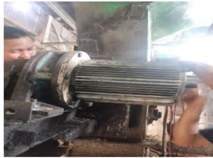
**Gambar 3.42 Memasang elektro motor 3 phasa pada aerlok**
