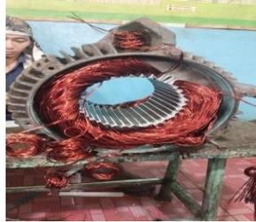
**Gambar 3.57 Pemasangan *email drat* elektro motor 3P 1500 RPM**
