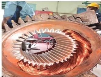
**Gambar 3.6 Memasang kumparan elektro motor 3 phasa**
