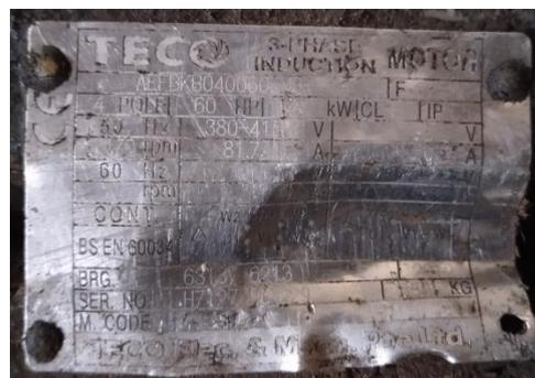
**Gambar 4.9 *Name plate* elektro motor 3P**
