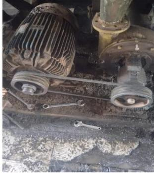
**Gambar 3.86 Penggantian *pulle dutro cyclone***
