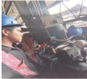
**Gambar 3.111 Pemasangan elektro motor pompa *hidrolik***
