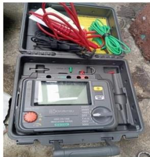
**Gambar 3. 102 Pengukuran tahanan isolasi *transformator***
