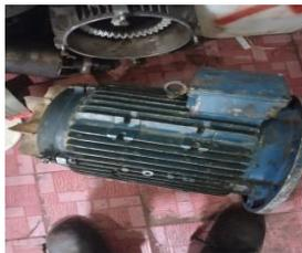
**Gambar 3.77 Perakitan elektro motor 3 phasa**
