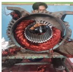
**Gambar 3.56 Pemasangan *email drat* elektro motor 3P 1500 RPM**
