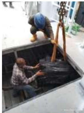
Gambar 2.8. 3 pemasangan mesin di kapal pilot boat
