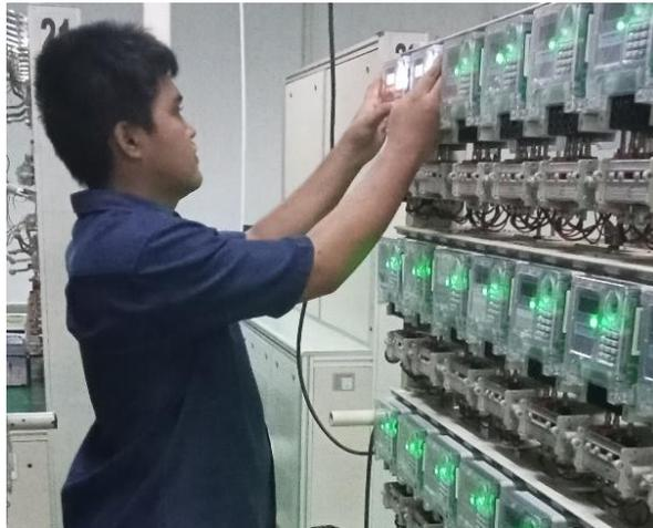
Gambar 3. 5 Pengujian Mobile Debugging Prabayar DDSY 837
