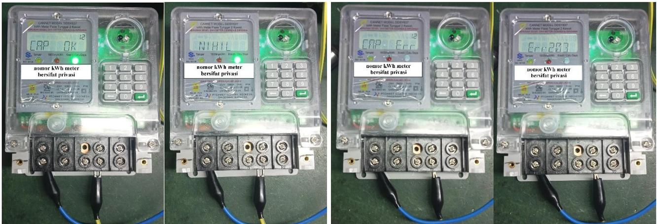
Gambar 3. 11 Contoh Reject kWh Error 203 atau kapasitor error
