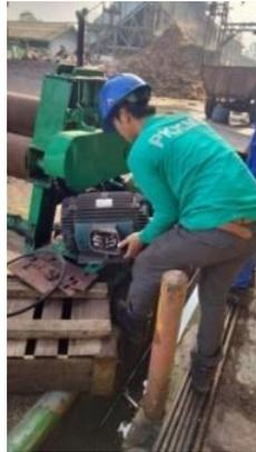
**Gambar 3. 38 Pemasangan motor roll.**
