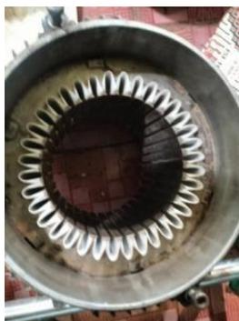
**Gambar 4. 6 Pemasangan isolasi slot**
