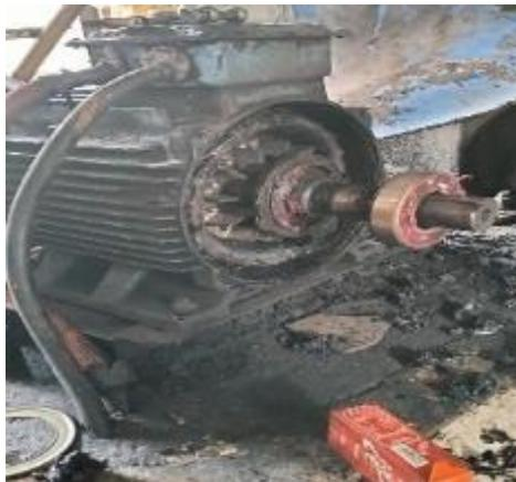
**Gambar 3.60 Pembongkaran & Pemasangan *Bearing***
