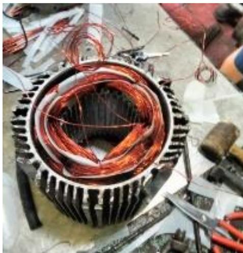
**Gambar 3.21 Memasang Presspan**
