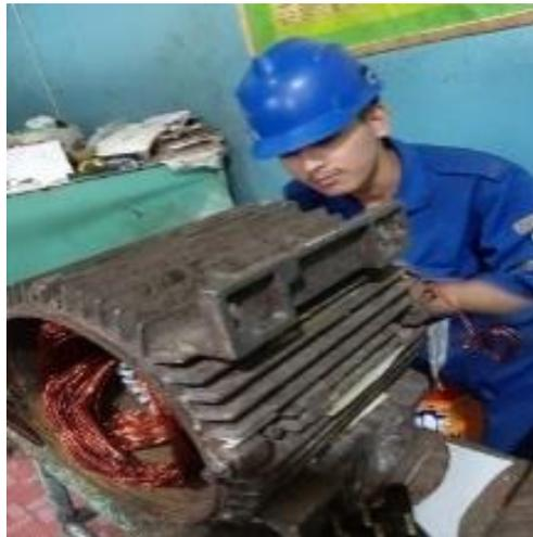
**Gambar 3.73 Pemasangan Kawat Belitan Stator Elektro Motor Pompa Kcp**
