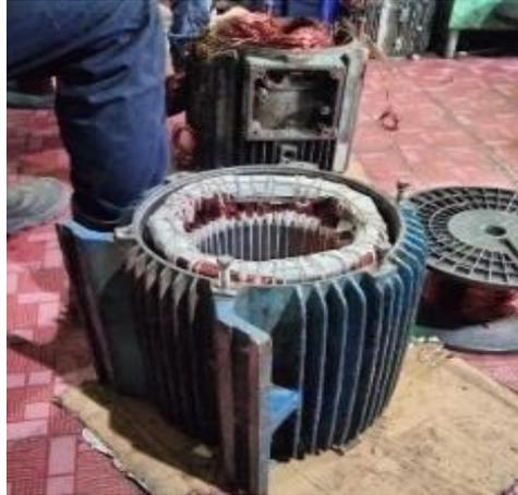
**Gambar 3.89 Pengikatan Belitan Stator**
