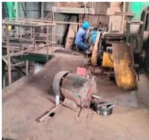
**Gambar 3.65 Pemasangan Pully & Balting**
