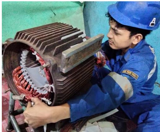
**Gambar 4.14 Pemasangan Belitan Stator**
