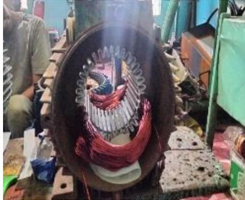
**Gambar 3.71 Pemasangan Kawat Belitan Stator**
