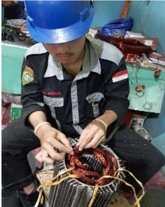
**Gambar 3.43 Perbaikan & Pengikisan Beiltan Stator**
