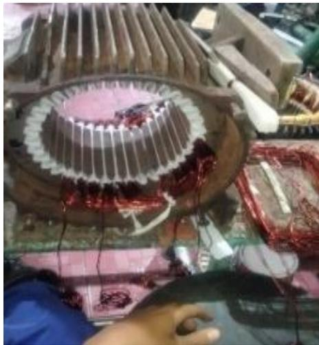
**Gambar 3.51 Pemasangan Kawat Belitan Stator**
