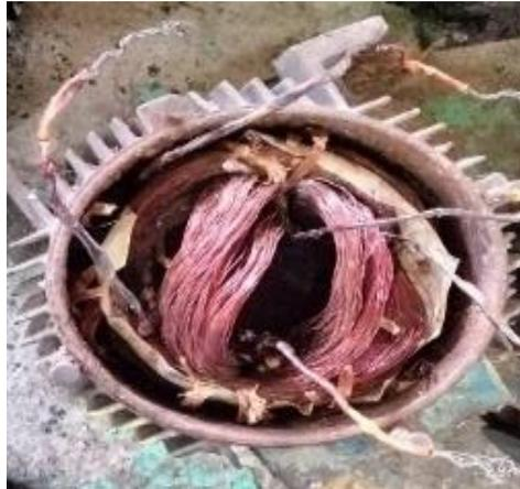
**Gambar 3.64 Pemotongan Kawat Belitan Stator Elektro Motor Pompa Kcp**
