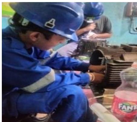
**Gambar 3.50 Pemasangan *Prespan***
