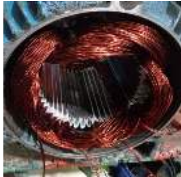
Gambar 3. 103 Menggulung elektro motor (Sumber : Dokumentasi 2025)
