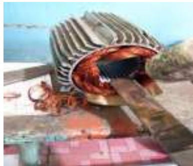
Gambar 3. 76 Menggulung elektro motor
