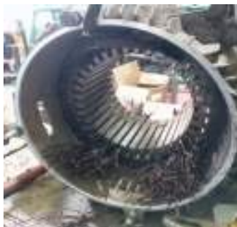
Gambar 3. 65 Membongkar elektro motor (Sumber : Dokumentasi 2025)
