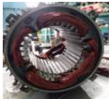
Gambar 3. 31 Pemasangan email drat elektro motor (Sumber : Dokumentasi 2025)
