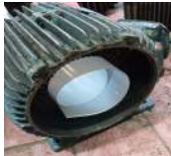
Gambar 3. 92 Cleaning elektro motor (Sumber : Dokumentasi 2025)
