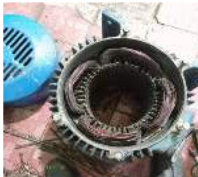
Gambar 3. 90 Membongkar elektro motor capstan (Sumber : Dokumentasi 2025)
