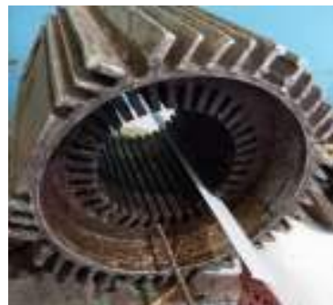
Gambar 3. 59 Membersihkan jalur elektro motor (Sumber : Dokumentasi 2025)
