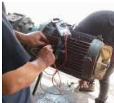
Gambar 3. 83 Memperbaiki elektro motor (Sumber : Dokumentasi 2025)
