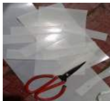
Gambar 3. 93 Memotong prespan sebagai isolator stator (Sumber : Dokumentasi 2025)
