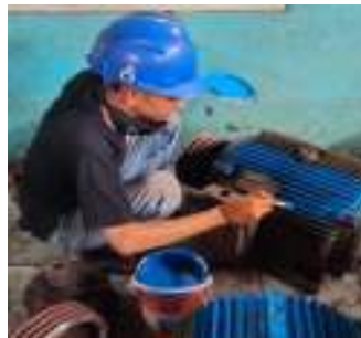
Gambar 3. 52 Pengecatan elektro motor (Sumber : Dokumentasi 2025)
