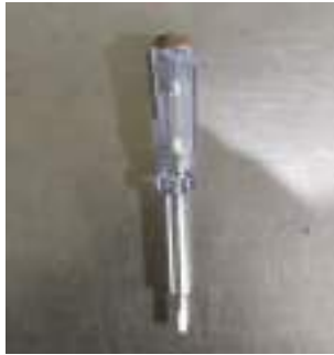
Gambar 3. 130 Test Pen (Sumber : Dokumentasi 2025)
