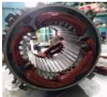
Gambar 3. 31 Pemasangan email drat elektro motor (Sumber : Dokumentasi 2025)
