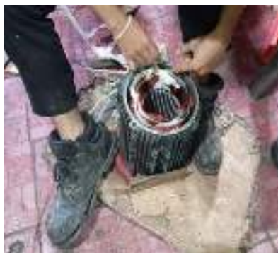
Gambar 3. 57 Menjahit gulungan elektro motor (Sumber : Dokumentasi 2025)
