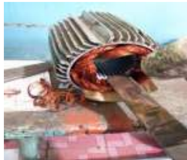
Gambar 3. 76 Menggulung elektro motor
