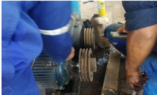
Gambar 3. 53 Pemeliharaan dan perawatan motor Root Blower unit 1A
