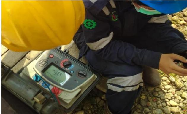
Gambar 3. 63 Megger pada proteksi Main Transformer unit 2
