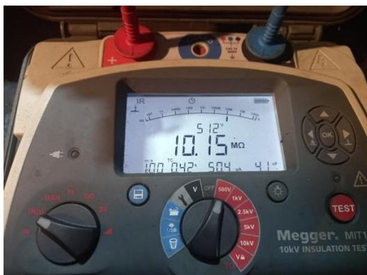
**Gambar 4. 28** Pengukuran Insulation Tester pada motor OCCWP
