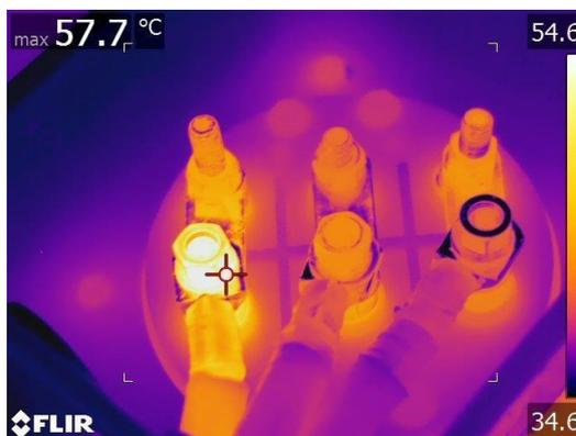
**Gambar 4. 18** Pengukuran thermovisi pada terminal motor
