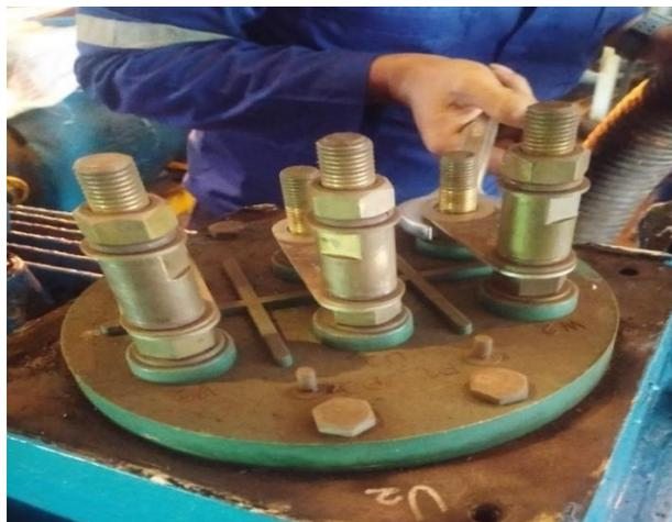
**Gambar 4. 25** Mengencangkan sambungan bagian bawah
