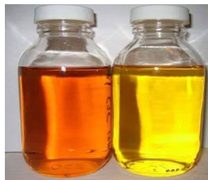
Gambar 4. 6 Minyak Isolasi Transformator
