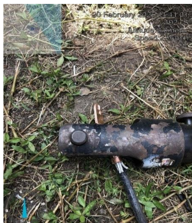
Gambar 2.34 Pengepresan skun untuk Grounding
