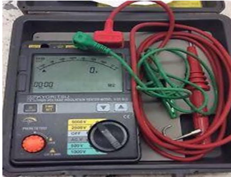
Gambar 3.37 megger box panel di area cdu
