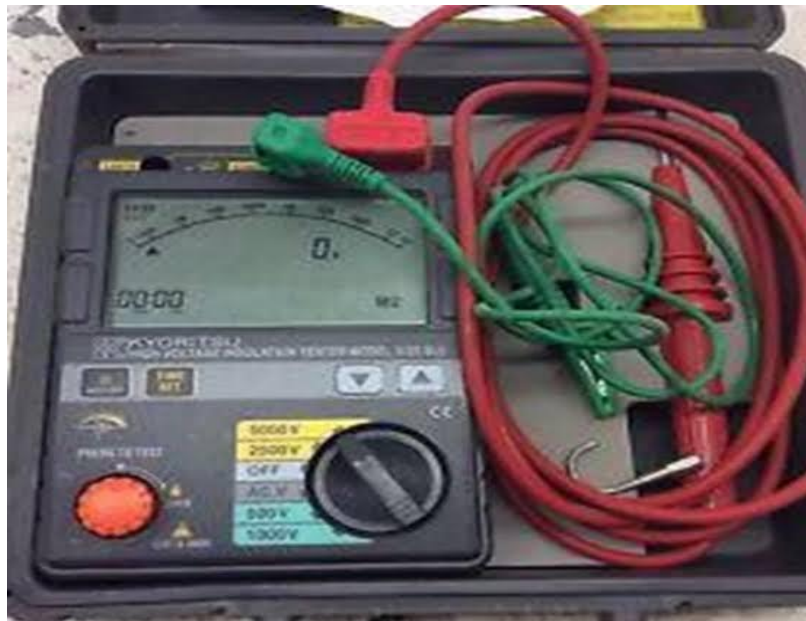
Gambar 3.28 megger box panel di area cdu
