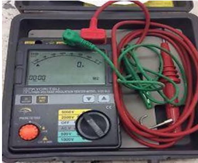
Gambar 3.21 megger motor di area kolam
