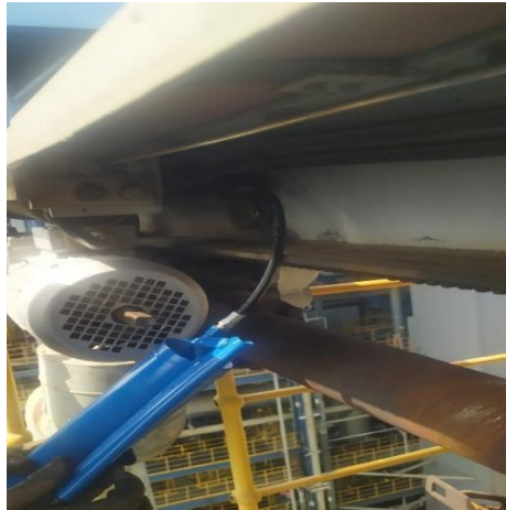
Gambar 4. 23 Pelumasan Pada Batang Penghubung (Sumber: Dokumentasi Pribadi)
