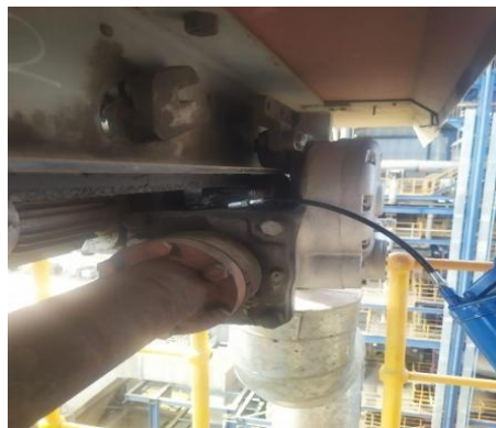
Gambar 4. 22 Pelumasan Pada Sprocket (Sumber: Dokumentasi Pribadi)
