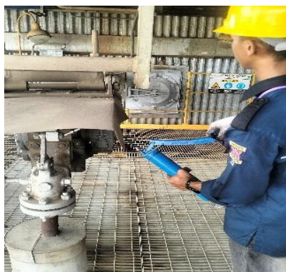
Gambar 4. 20 Pelumasan Pada Stamp (Sumber: Dokumentasi Pribadi)
