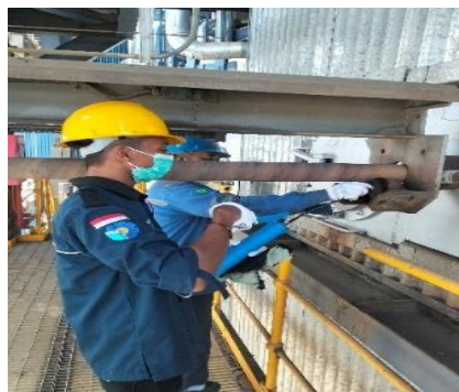
Gambar 4. 14 Pelumasan Pada Roller (Sumber: Dokumentasi Pribadi)
