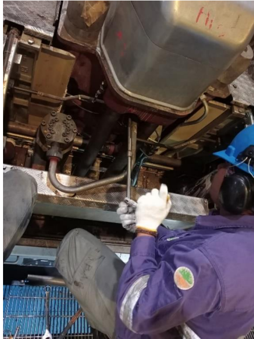
Lampiran 1 Melepaskan Injection Pump dari Unit
