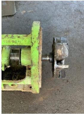
Gambar 4.11 Pembongkaran Casing impeller
