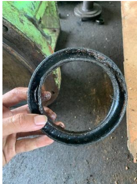
Gambar 4.13 Pembongkaran Mechanical Seal.
