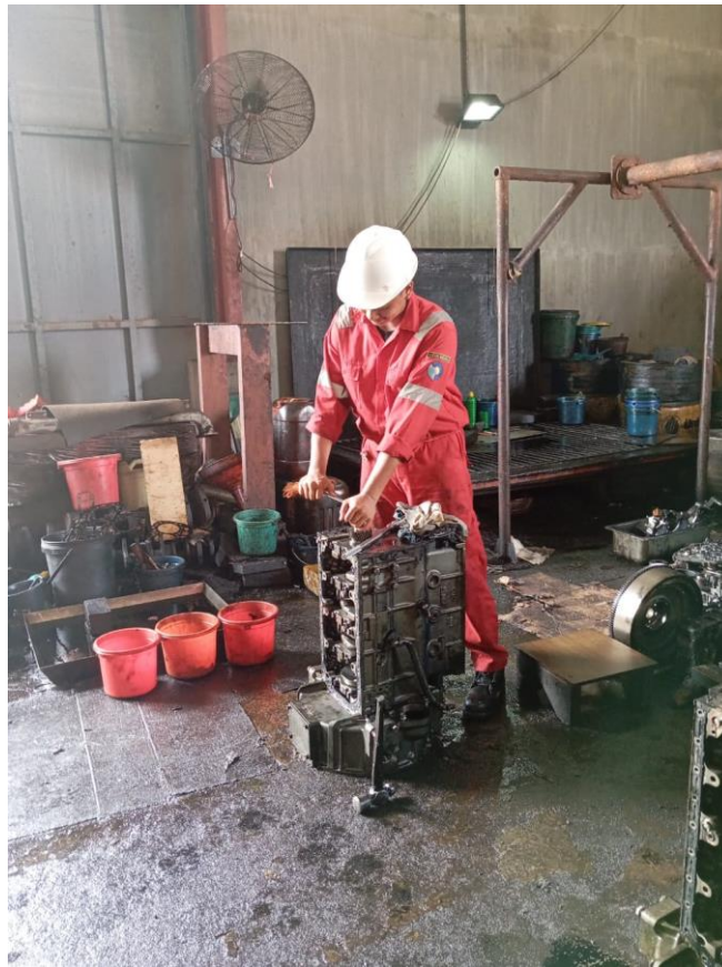
Gambar 3. 2 Melakukan Pelepasan Krenaaft Dari Blok Silinder
