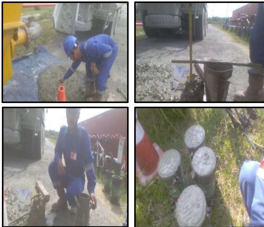
Gambar 3.15 Pengujian sampel beton silinder dan slump tes (Sumber: Dokumentasi Lapangan, 2024)
