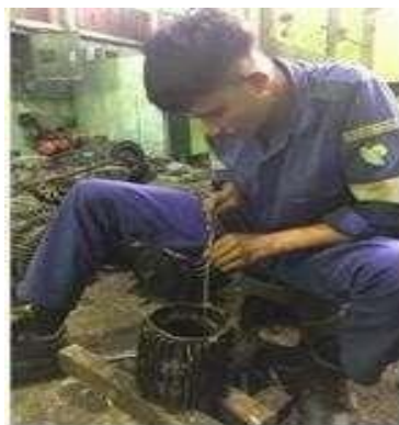
Gambar 3.53 Pembersihan Elmot (Sumber: Dokumentasi di PTPN IV Sei Buatan,2025)
