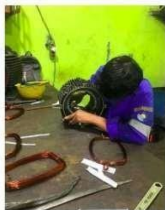
Gambar 3.27 Penggulungan Email Drat Ke Elmot (Sumber: Dokumentasi di PTPN IV Sei Buatan, 2025)
