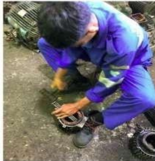
Gambar 3.25 Penggulungan Email Drat Sebanyak 40 Gulungan (Sumber: Dokumentasi di PTPN IV Sei Buatan, 2025)
