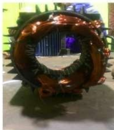
Gambar 3.43 Penggulungan Email Drat Ke Elmot (Sumber: Dokumentasi di PTPN IV Sei Buatan,2025)
