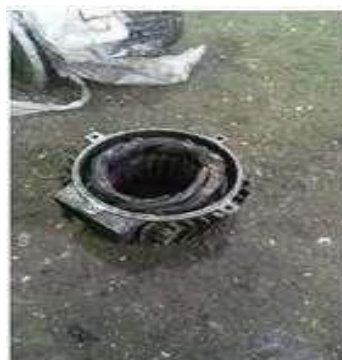
Gambar 3.49 Pembongkaran Emot Yang Kebakar (Sumber: Dokumentasi di PTPN IV Sei Buatan, 2025)
