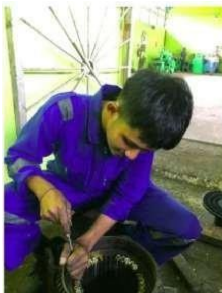
Gambar 3.59 Pembersihan elmot (Sumber: Dokumentasi di PTPN IV Sei Buatan, 2025)
