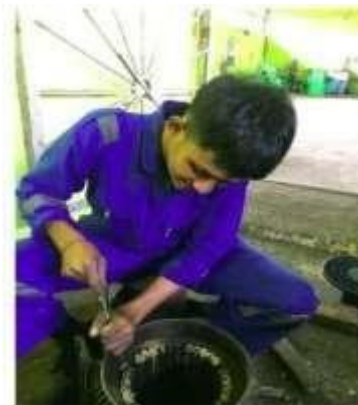
Gambar 3.22 Pembersihan Elmot Yang Kebakar (Sumber: Dokumentasi di PTPN IV Sei Buatan,2025)
