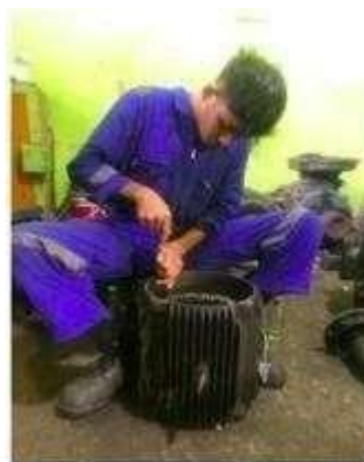
Gambar 3.61 Pembersihan elmot elmot dari sisa kertas litroid yang terbakar (Sumber: Dokumentasi di PTPN IV Sei Buatan, 2025)
