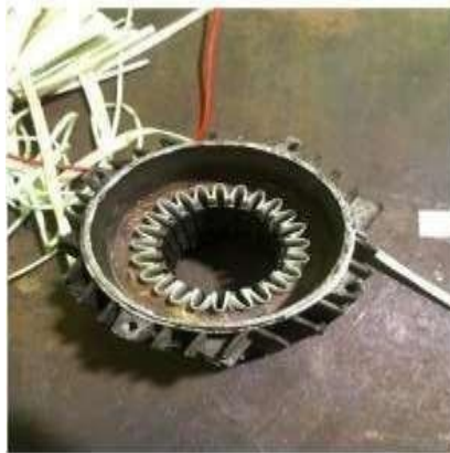
Gambar 3.29 Pemasangan Kertas Litroid Ke Elmot (Sumber: Dokumentasi Di PTPN IV Sei Buatan,2025)
