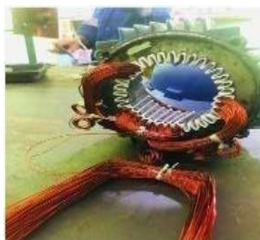
Gambar 3.42 Pemasangan Lilitan Email Drat Ke Stator Elmot (Sumber: Dokumentasi Di PTPN IV Sei Buatan, 2025)
