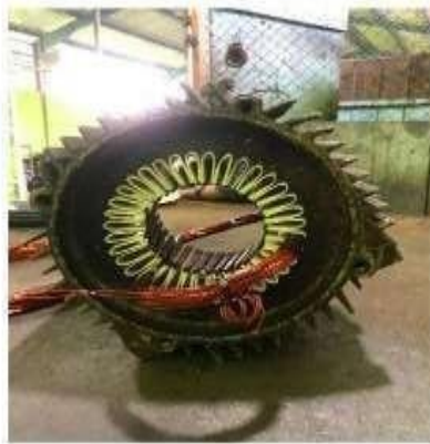
Gambar 3.24 Pemasangan Lilitan Email Drat Ke Stator Elmot (Sumber: Dokumentasi Di PTPN IV Sei Buatan,2025)
