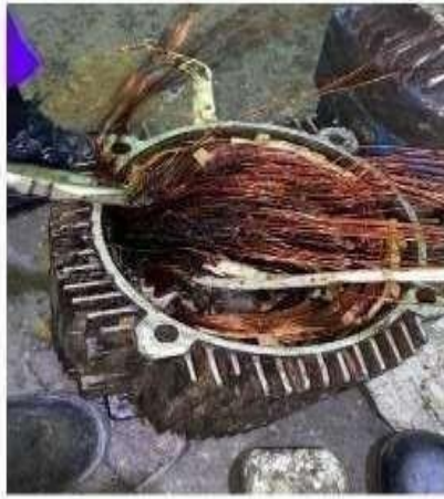
Gambar 3.64 Pembongkaran Lilittan Elmot Yang Terbakar (Sumber: Dokumentasi Di PTPN IV Sei Buatan,2025)
