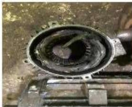
Gambar 3.39 Pembongkaran Lilittan Elmot Yang Terbakar (Sumber: Dokumentasi Di PTPN IV Sei Buatan,2025)
