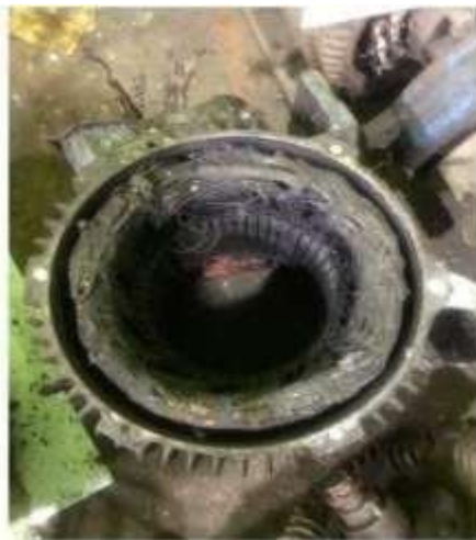
Gambar 3.48 Pembongkaran Lilittan Elmot Yang Terbakar (Sumber: Dokumentasi Di PTPN IV Sei Buatan, 2025)
