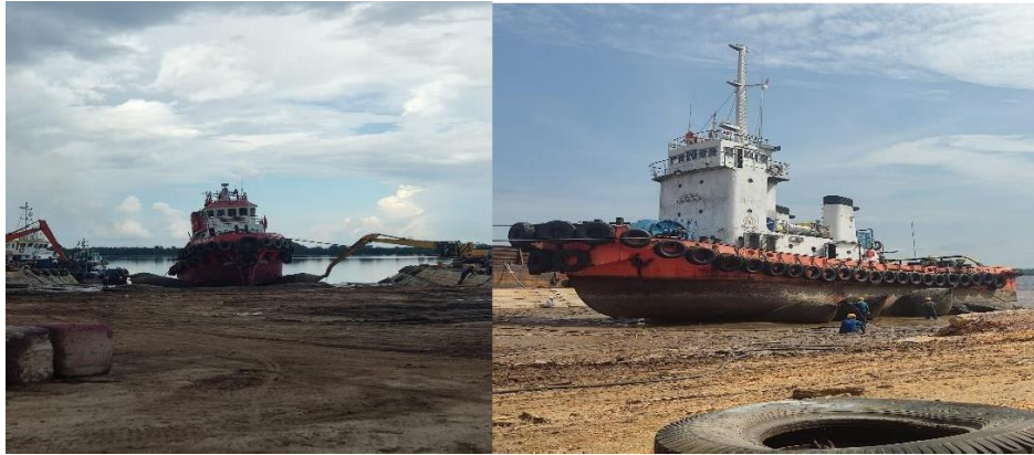
Gambar 1.8. Fasilitas Docking/Undocking Menggunakan Sistem Docking Slipway
