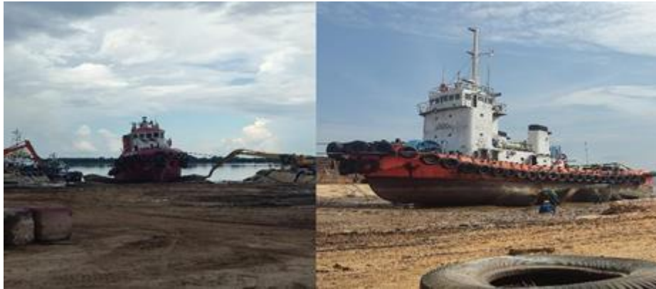
Gambar 1. 8 Fasilitas Docking/Undocking Menggunakan Sistem Docking Airbag
